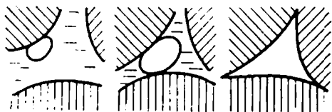
Рис. 84. Схема формирования газоусадочной поры
